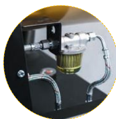
Brændstofforvarmer er tilvalg, brændstoffilteret indvendigt
