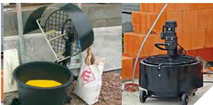
**Integrierter Transportwagen mit Zugstange**
