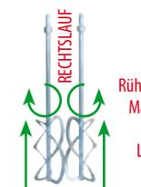
Rührquirlen arbeiten sich in das Material ein und befördern es nach oben, geringe Luftfeinschlüsse, leichtes Führen
