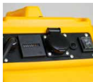
DFX 20 kontrolpanel - timetæller, ekstra strømstik, kontakt til valg af hastighed
