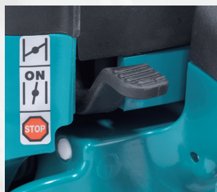
Touch & Stop-kontakt letter start og stop af maskinen
