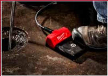
Elektronisk fodpedal så begge hænder kan bruges
