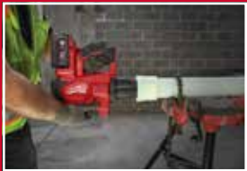
Stabil bund til brug som stationær maskine
