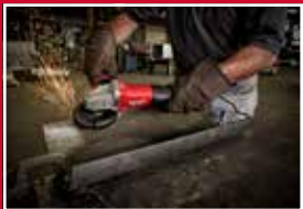
Sikkerhedskobling forhindrer "kickback"-effekten
