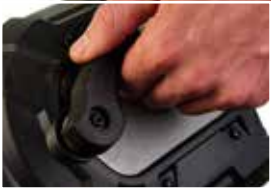
Praktisk klingskift uden brug af værktøj/nøgle
