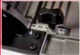
Dobbelt beskyttelsesskærm hæfter på både front og bag
