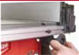
Hegnet kan justeres let og hurtigt fra fronten hvilket giver en kapacitet på 622 mm
