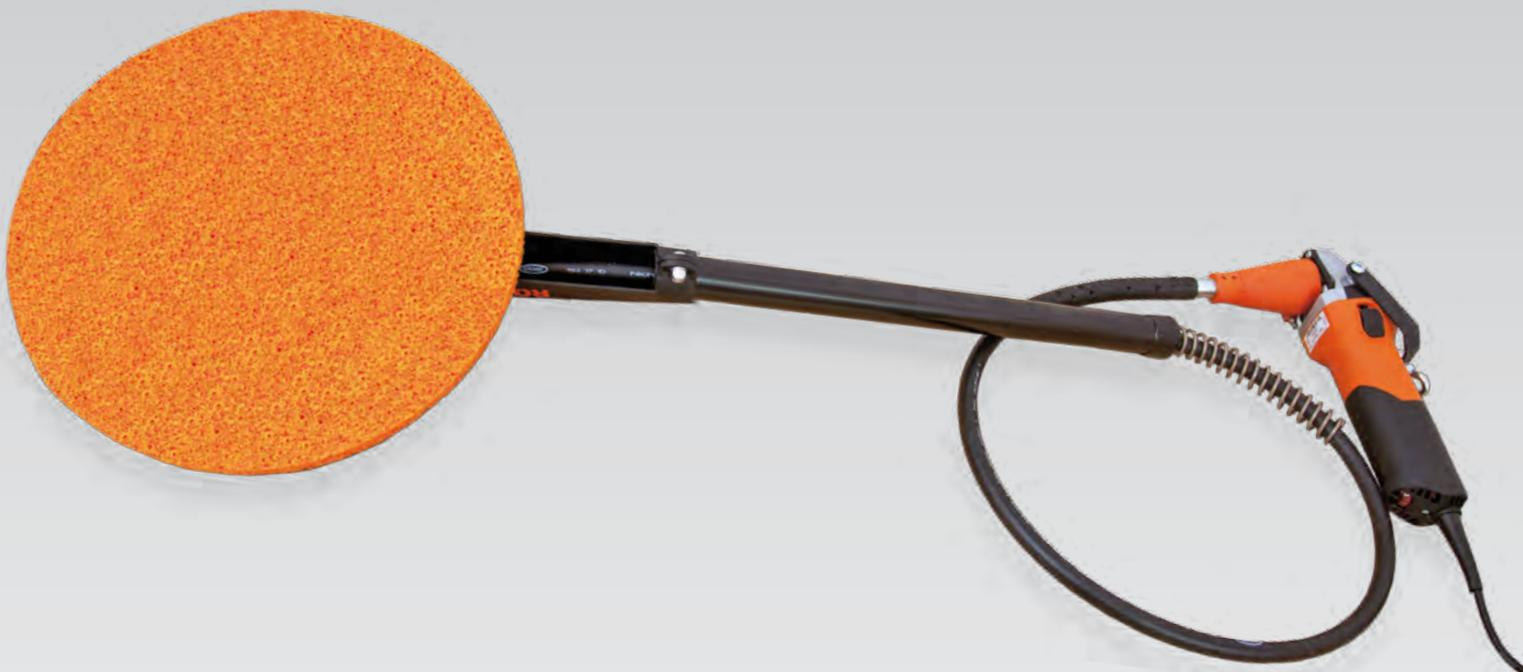
▸ Bearbeiten von Gipsputz, Kalk-Zementputz, Lehmputz und Scheibenputz
