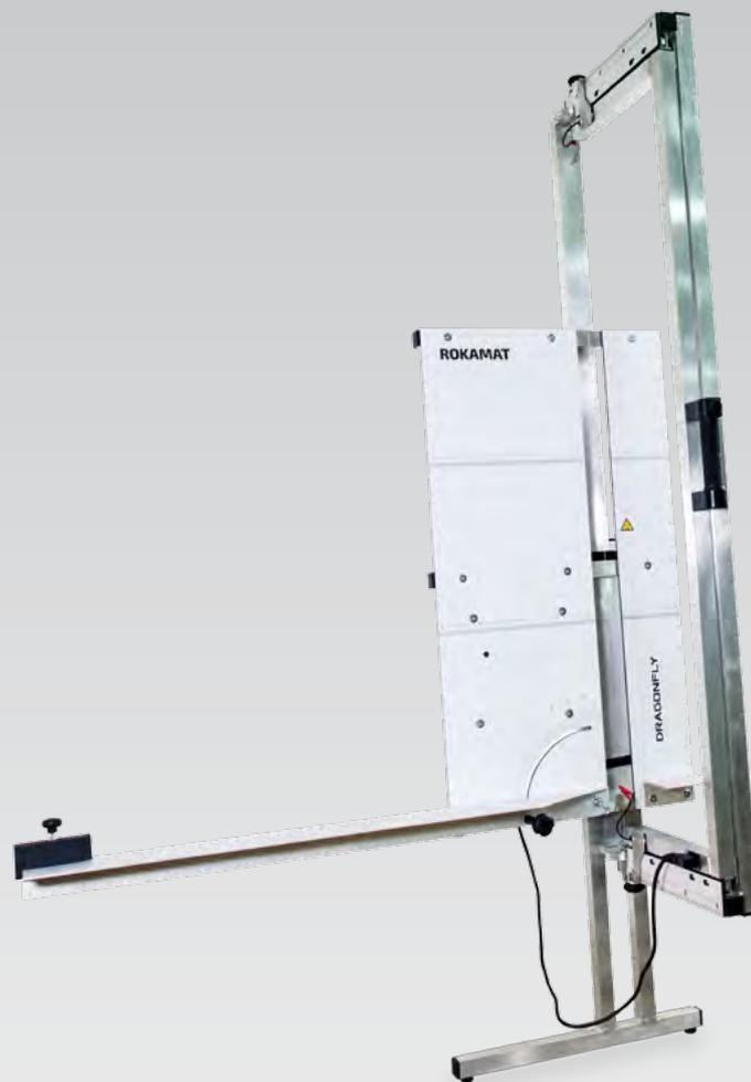
► **Thermisches Schneiden von EPS-Hartschaum-Dämmplatten**
