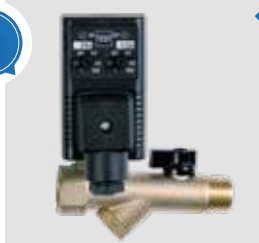
◀ Aut. vandaftapning tømmes automatisk kompressorens beholder for vand. Det giver optimal drift og kompressoreren har en længere levetid.
